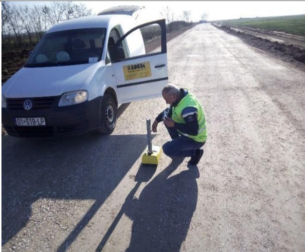
Testimet e shtresës së epërme të binarëve
